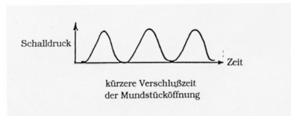
Abbildung 2.20: Sinusförmige Schwingungskurve bei schwerem Rohrblatt
